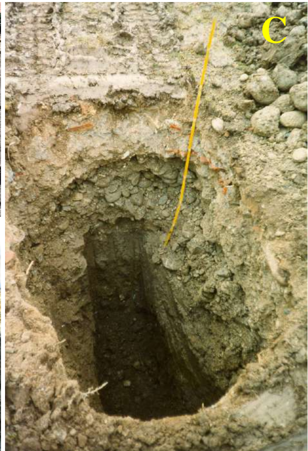
Scavi o spaccati sui terreni alluvionali e fluvio-glaciali su cui è ubicato l'abitato di Vertova: A) spaccato della frana del muro di via IV Novembre con riporti e terreno fluvio-glaciale; B) scavo presso rotatoria SS671; C) scavo nel campo sportivo di Vertova per la realizzazione delle torri faro in cui si nota il materiale ghiaioso ciottoloso sciolto o in matrice limoso sabbiosa.
