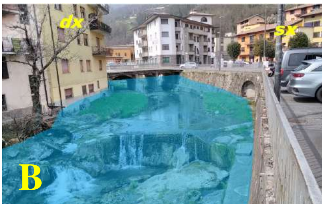
Livello di piena centennale del torrente Vertova in corrispondenza del tratto di torrente immediatamente a monte del ponte di via don Ferrari (A) e a valle del ponte di via IV Novembre – Largo Vittorio Veneto (B). Pericolosità per esondazione torrentizia lungo la val Masna (C)
