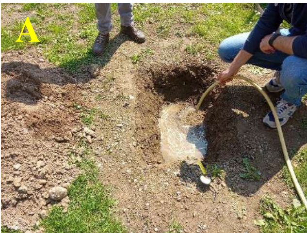
Esempio di prova di permeabilità in pozzetto (A) o con infiltrometro ad anello (B) per valutare la permeabilità del terreno e relativa valutazione analitica con grafico
