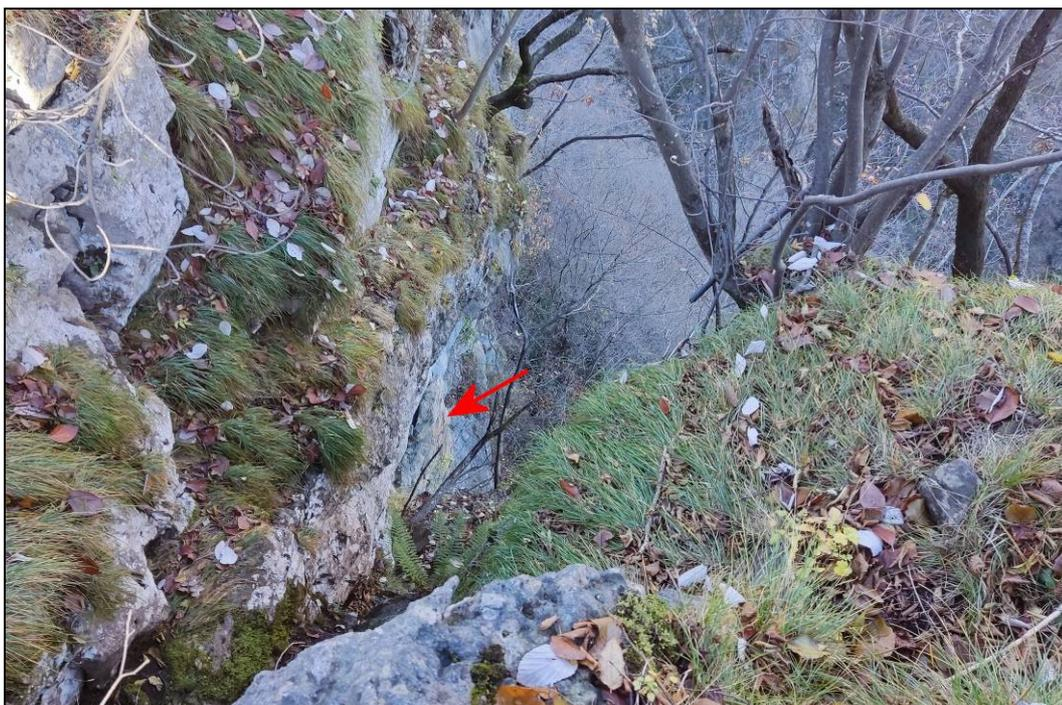
Foto 54: Lama rocciosa con un volume stimabile in circa 3 m<sup>3</sup> distaccatasi da una parete strapiombante, non è stato possibile osservarne la base d'appoggio ma visivamente appare alquanto instabile (versante destro, zona sovrastante il 2° "guado con passerai" della strada di servizio che percorre il fondovalle).
