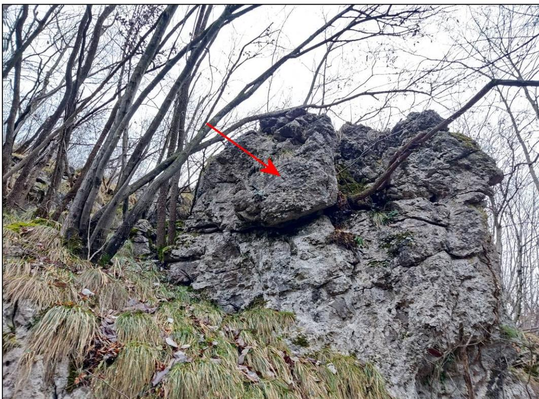
Foto 80: Porzione rocciosa di circa 1.6 m<sup>3</sup> di volume quasi completamente isolata a tergo ed alla base da una frattura beante per carsismo, entro cui cresce l'apparato radicale di una pianta (versante sinistro, zona sovrastante "Stalle Canet").
