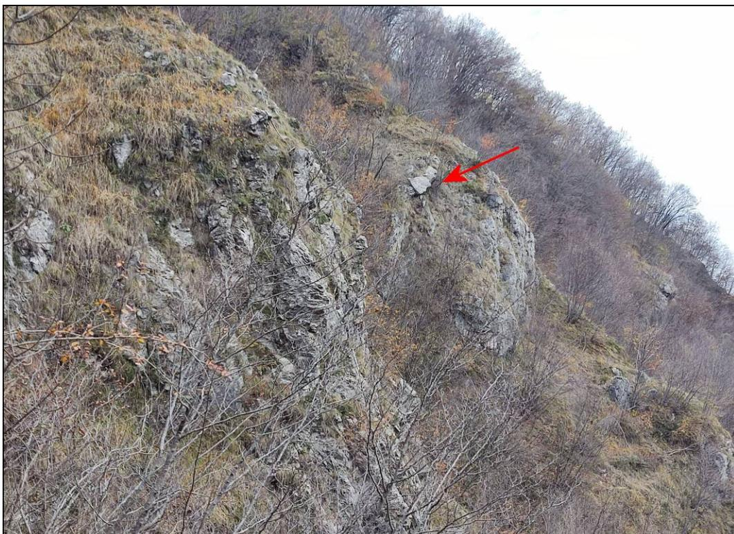
Foto 71: Masso tabulare di  $\approx 0.15 \text{ m}^3$  arrestatosi in posizione precaria alla sommità di una balza rocciosa (versante sinistro, ad est della località Melgher).
