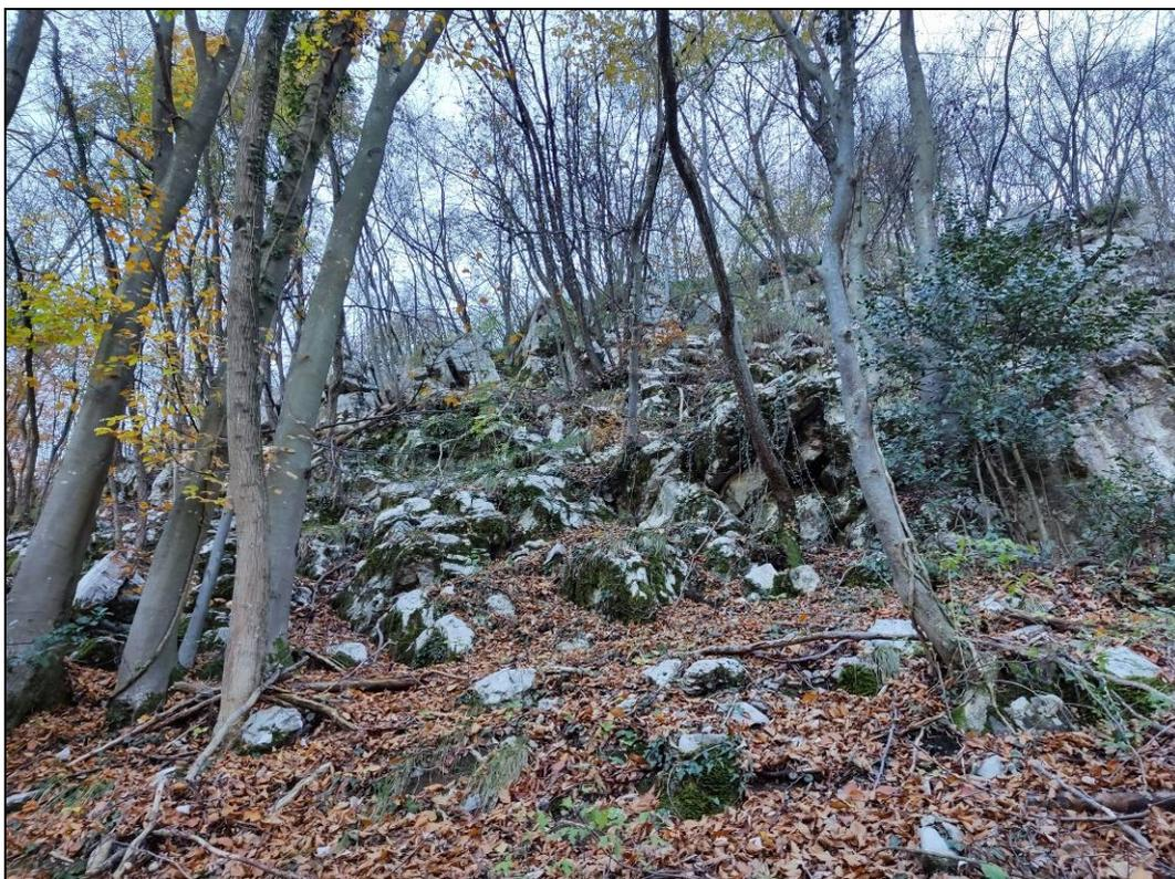
Foto 24: Porzione d'ammasso rilasciata con diversi blocchi smossi, quelli di maggiori dimensioni (1.5÷2.5 m<sup>3</sup>) sono basculati e poggiano l'uno sull'altro (zona RS8).
