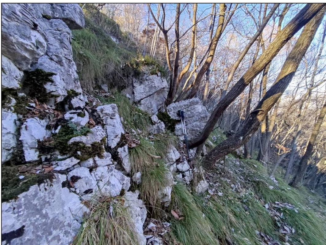
Foto 10: Blocco di 0.4 m<sup>3</sup> completamente isolato a tergo da una frattura beante e con la base per metà a sbalzo (zona tra RS1 e RS2).
