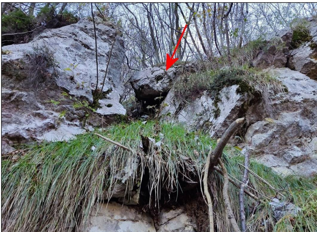
Foto 27: Blocco di  $\approx 1.3 \text{ m}^3$  ribaltatosi lateralmente e poggiante parzialmente su una superficie a franapoggio molto inclinata (zona ad est di RS8, nel tratto sottostante RS2-RS3).
