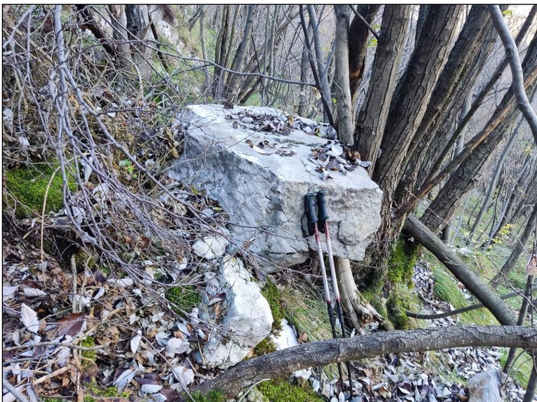
Foto 15: Masso di  $0.35 \text{ m}^3$  arrestatosi contro la vegetazione (tratto di pendio sottostante la zona tra RS3 e RS4).
